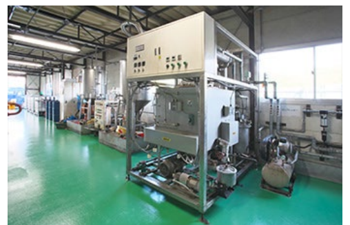
バイオディーゼル燃料の蒸留機
